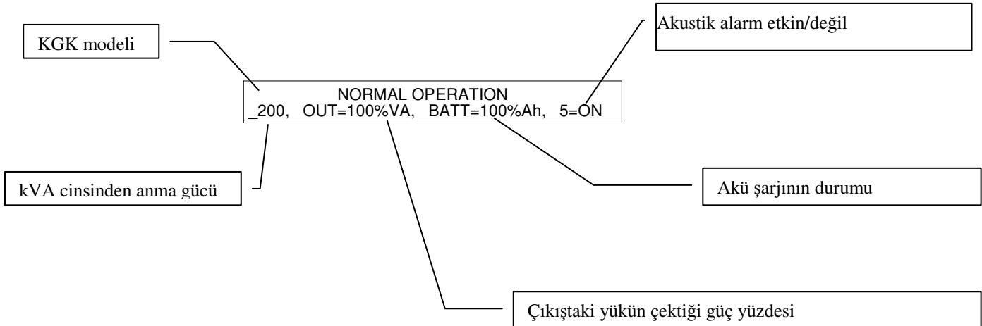
Yükün gücü eviriciden değil de (normal çalışma) bypass hattı aracılığıyla şebekeden geliyorsa OUT mesajı BY olarak değişir.
