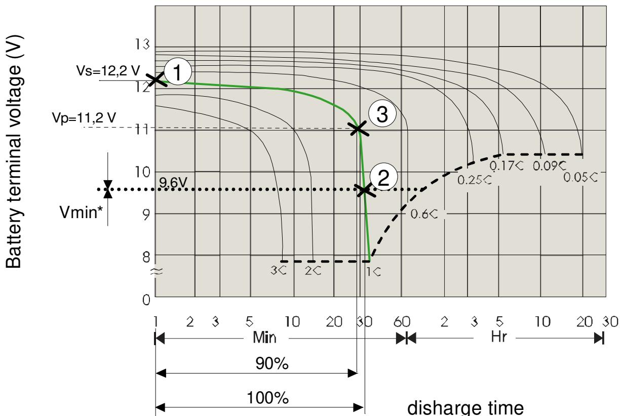
Bu üç değer, Vs, Vmin ve Vp, üreticiden sağlanan deşarj karakteristiği eğrisinden elde edilir, **akü deşarj rejimi** 1C saptanmıştır:
