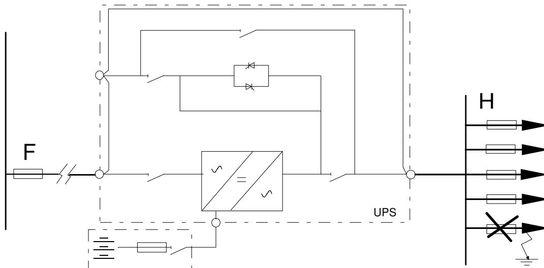
KGK'nın çıkış tesisatında kullanılacak koruma cihazlarının doğru seçilebilmesi için, şu iki işletim modeli göz önüne alınmalıdır: **sebeke güç kaynağı** ve **akü güç kaynağı**.
