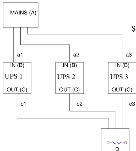
Şekil paralel bağlanmış üç birimin örneğini vermektedir.
