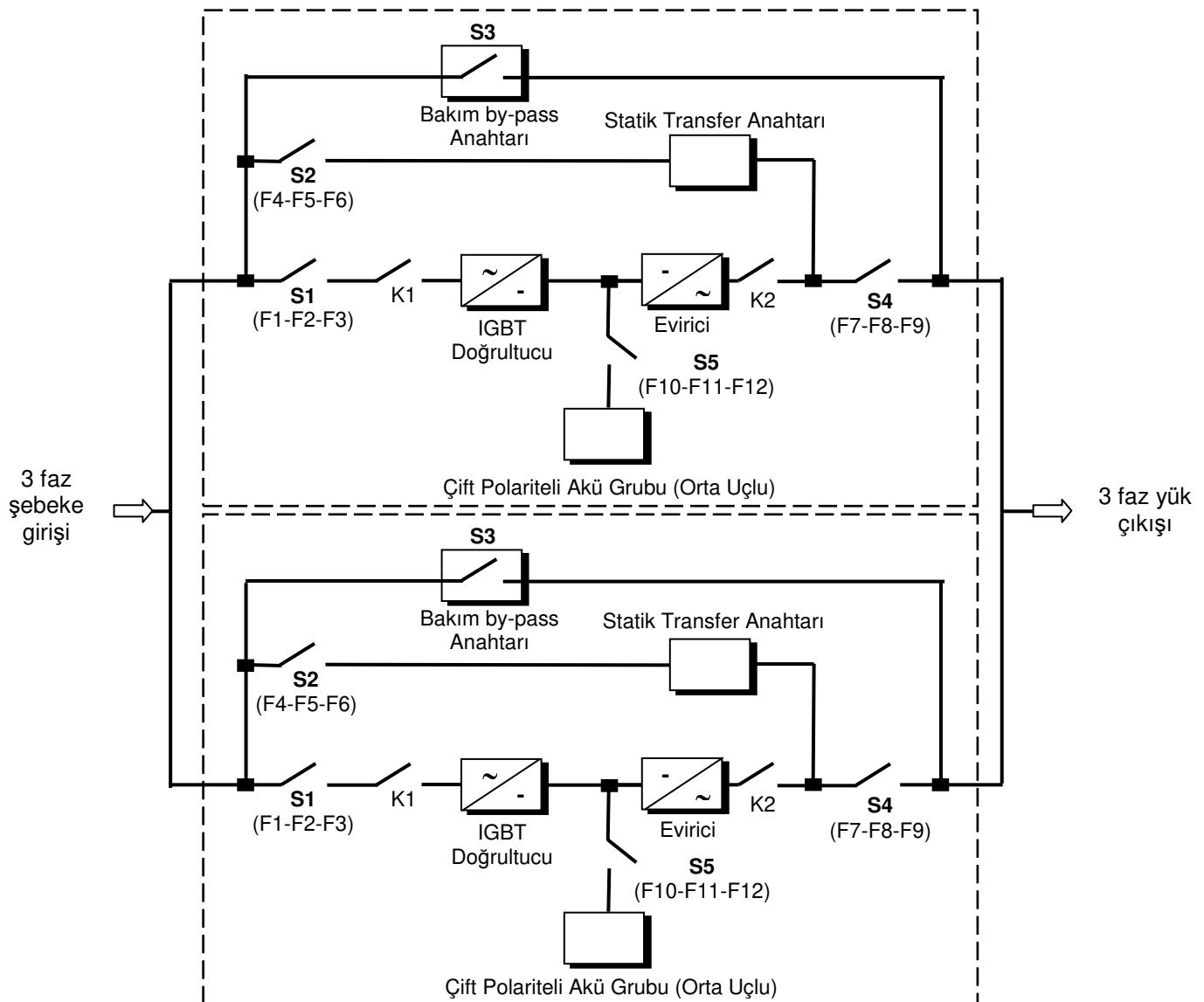
Şekil 5.1 İki DXA3000 KGK'nın Paralel Bağlantısı
