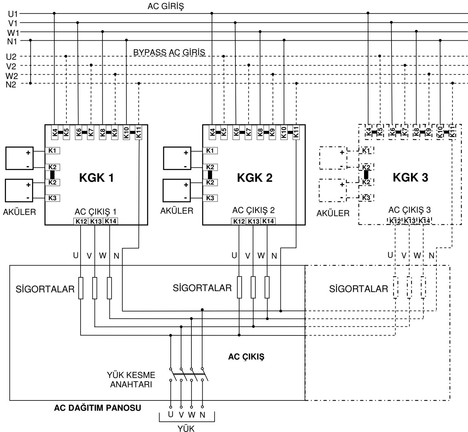
Şekil 4.3 DXA3000 Serisi Paralel KGK Güç Bağlantıları
