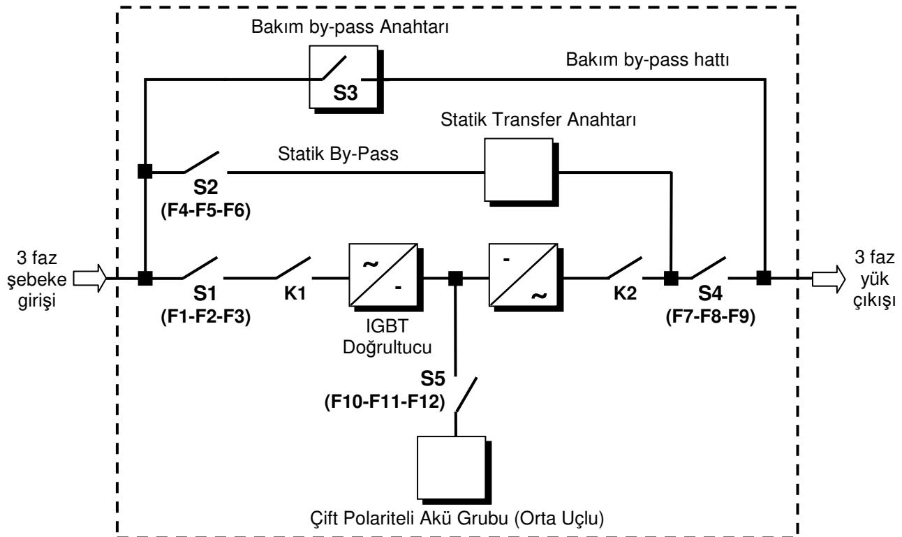
Şekil 1.1 DXA3000 Serisi UPS Blok Şeması
