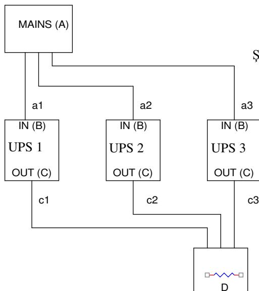
Şekil paralel bağlanmış üç birimin örneğini vermektedir.
