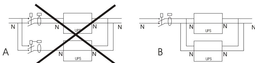
Gereksiz müdahalelerden kaçınmak için, şekil B'de gösterildiği gibi, çoklu paralel bağlanmış cihazların tümü sistemin girişine eklenmiş tek bir ortak ayırma şalteri (anahtarıyla) kullanmalıdır.
