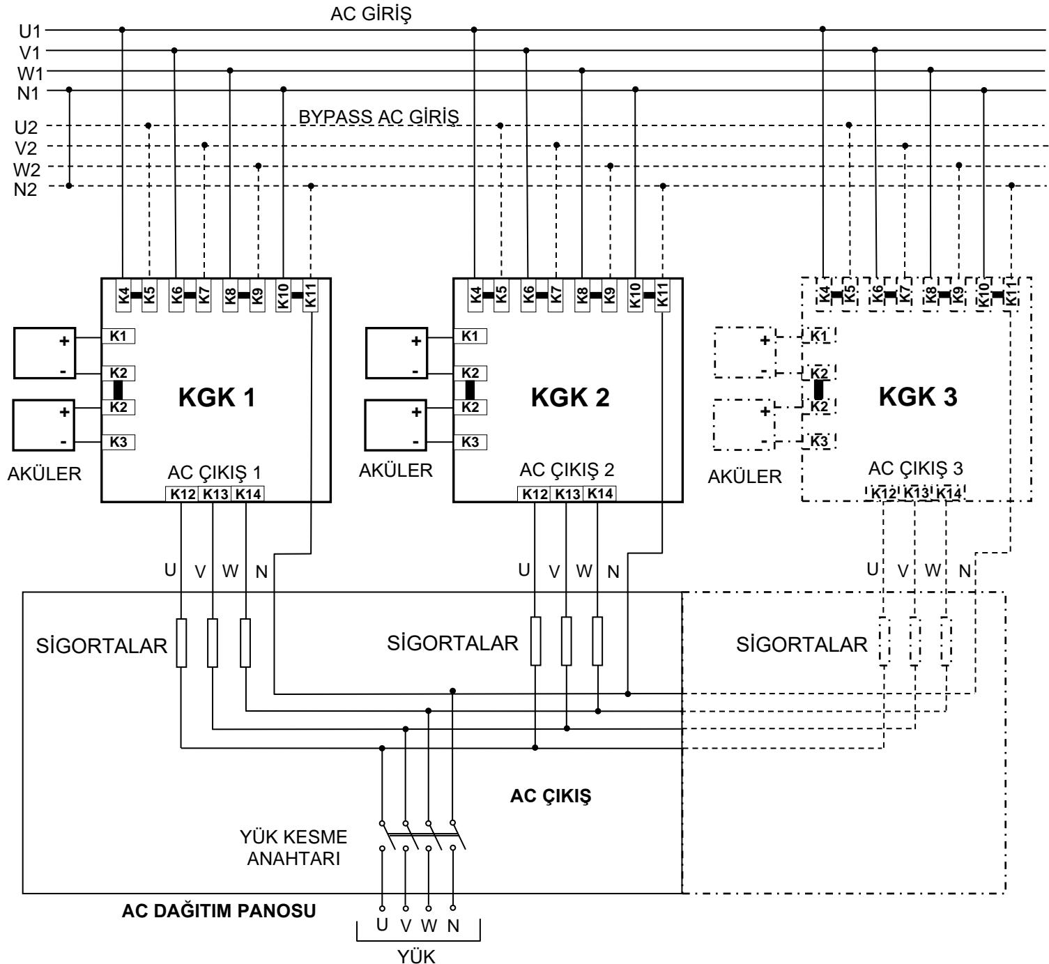
**Şekil 4.3** DX3000 Serisi Paralel KGK Güç Bağlantıları
