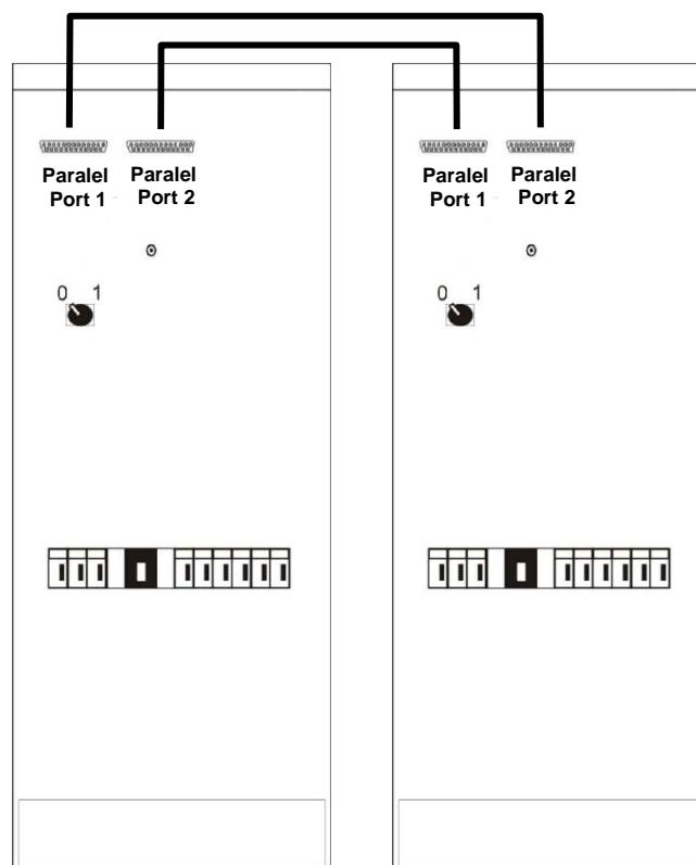
**Şekil 4.2.a 2 paralel KGK data bağlantısı (port2 atlaması çıkış)**
