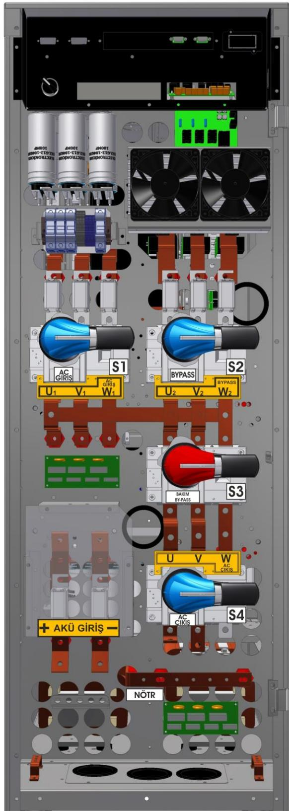
Şekil 2.2 100,120-150-160 ve 200kVA Kablo Bağlantısı
