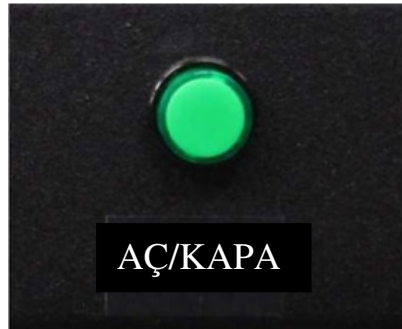
Resim 7: AÇ/KAPA butonu(kapalı konumunda)
