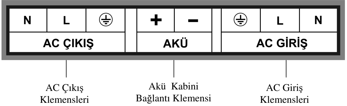
Şekil 1.3 KGK Elektriksel Bağlantı Açıklaması
