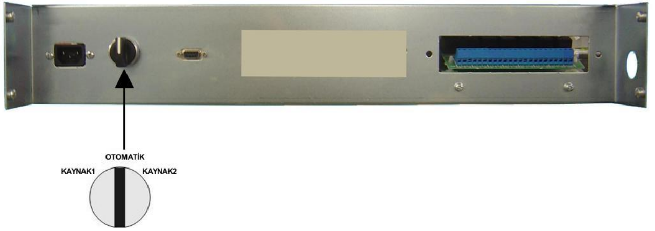
Şekil – 3 Elle transfer anahtarı konumu
