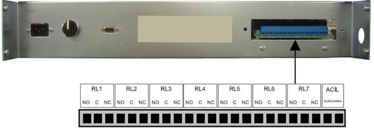
Şekil - 11 Alarm Röle kontak terminalleri ve REPO girişi
